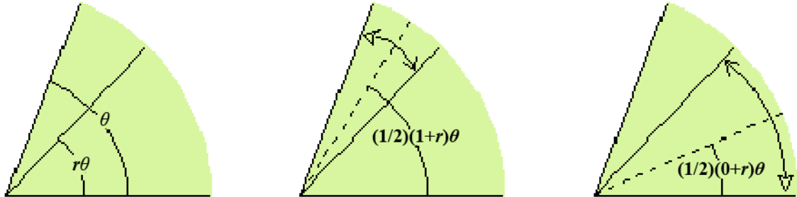
Рис. 30. Деление угла с помощью бисекции соответствует двум операциям, составляющим двоичный метод.
